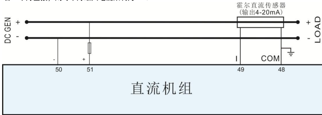
图 6 ALC704/708 控制直流机组时典型应用图
