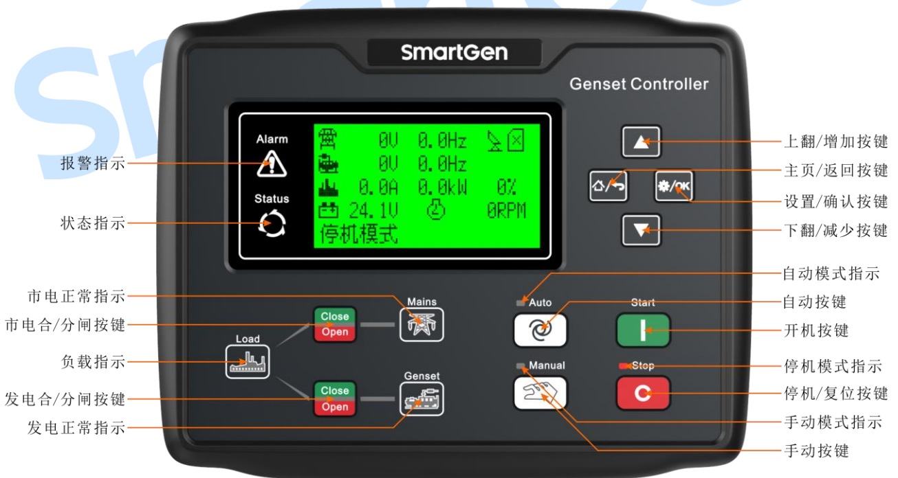
图2 HGM6120-4G (HGM6120N-4G /CAN-4G)前面板指示
