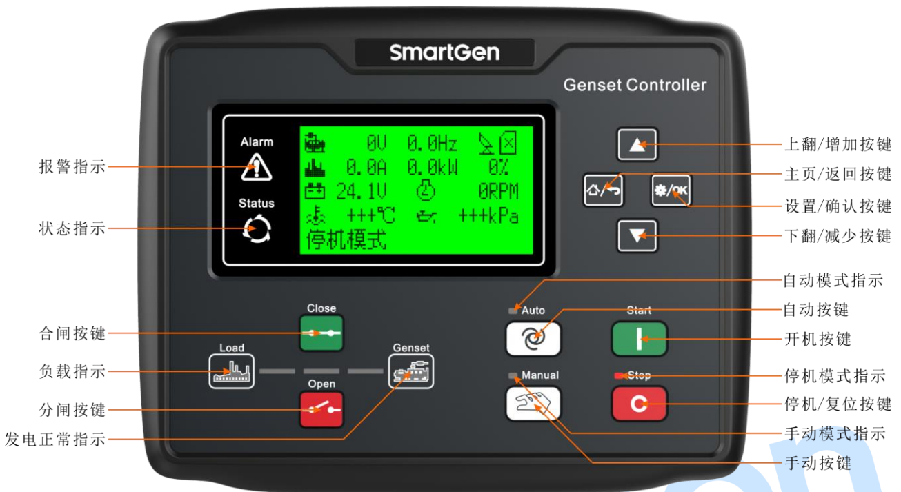
图1 HGM6110-4G(HGM6110N-4G/CAN-4G)前面板指示
