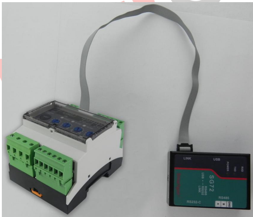
图2 PC 编程连接方式
