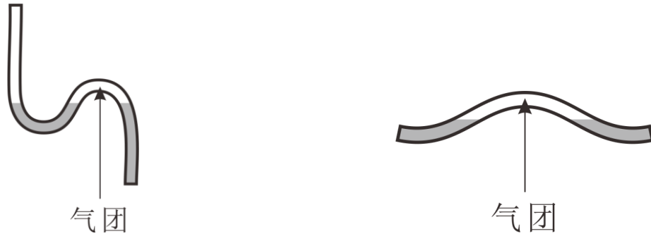
图3 错误的管道连接方法
