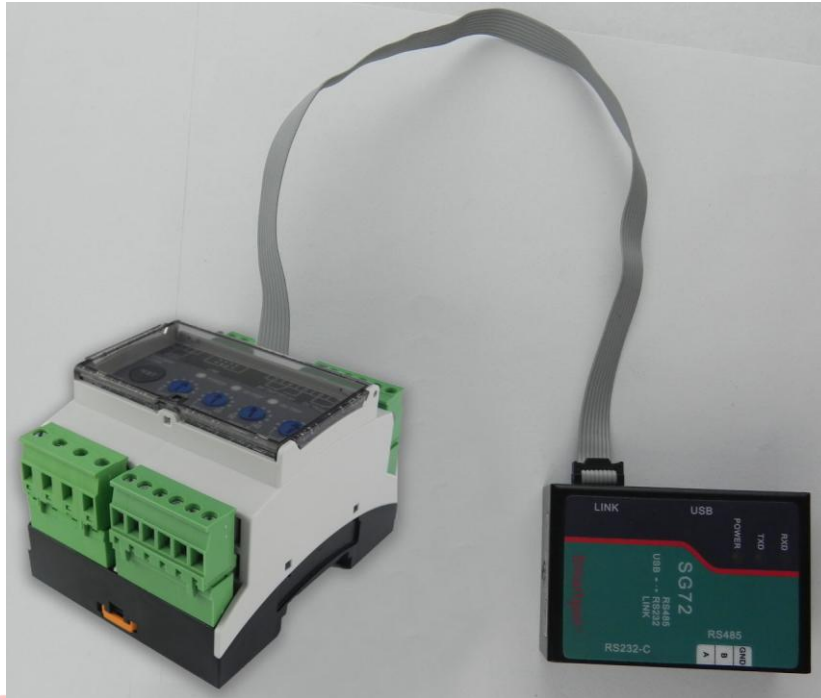
图2 PC 编程连接方式
