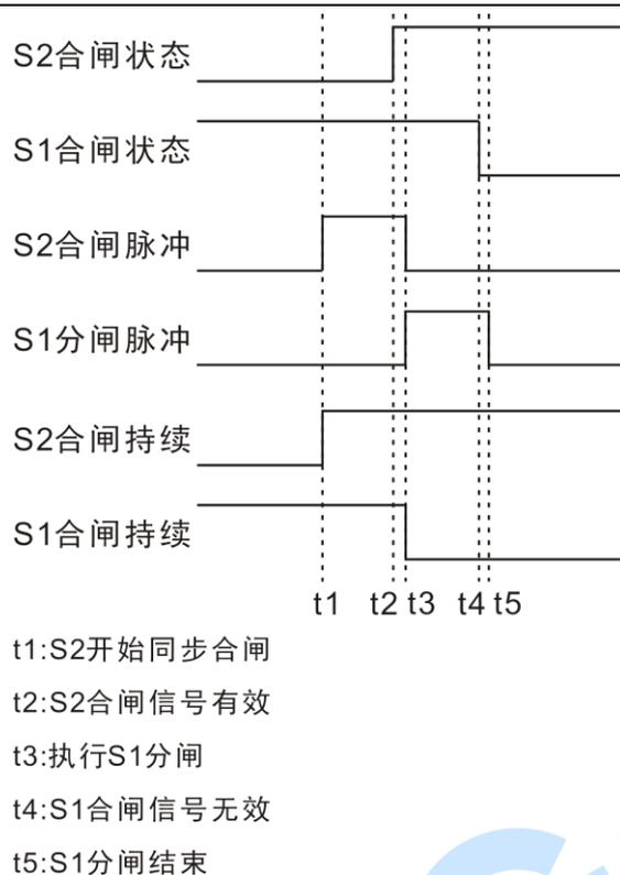
图9 S2 同步并联合闸过程波形图
