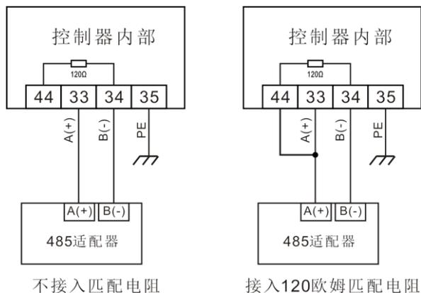
图21 RS485 连接示意图
