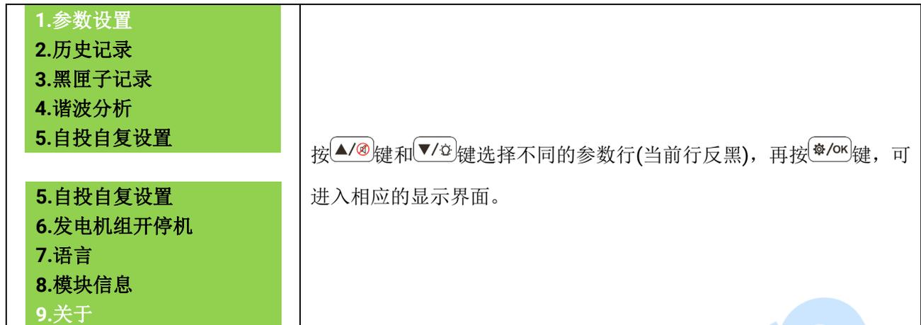
注：进入参数设置需要输入密码，默认密码为“01234”，操作员可更改密码，防止他人随意更改控制器配置。更改密码后请牢记，如忘记密码请与公司服务人员联系。
