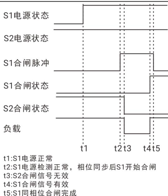
图10 S1 同相位合闸过程波形图
