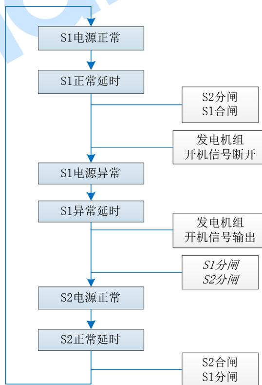
图3 自投自复流程图
