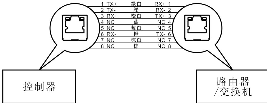
图16 控制器与路由器直连示意图
