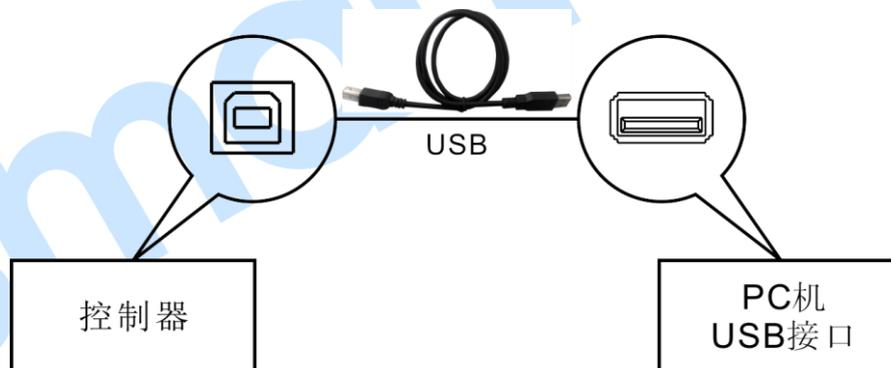
图15 USB 连接示意图
