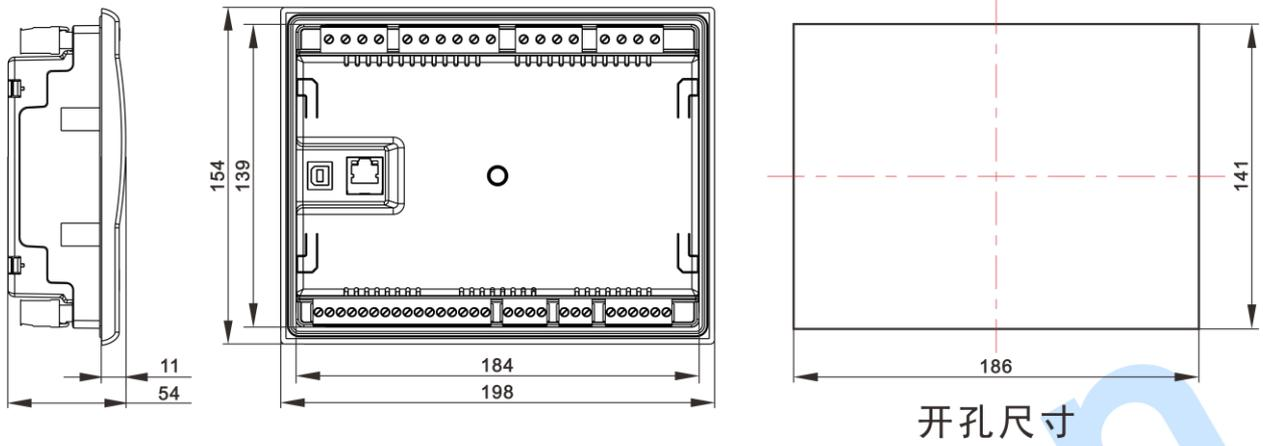
图28 外形尺寸及面板开孔尺寸
