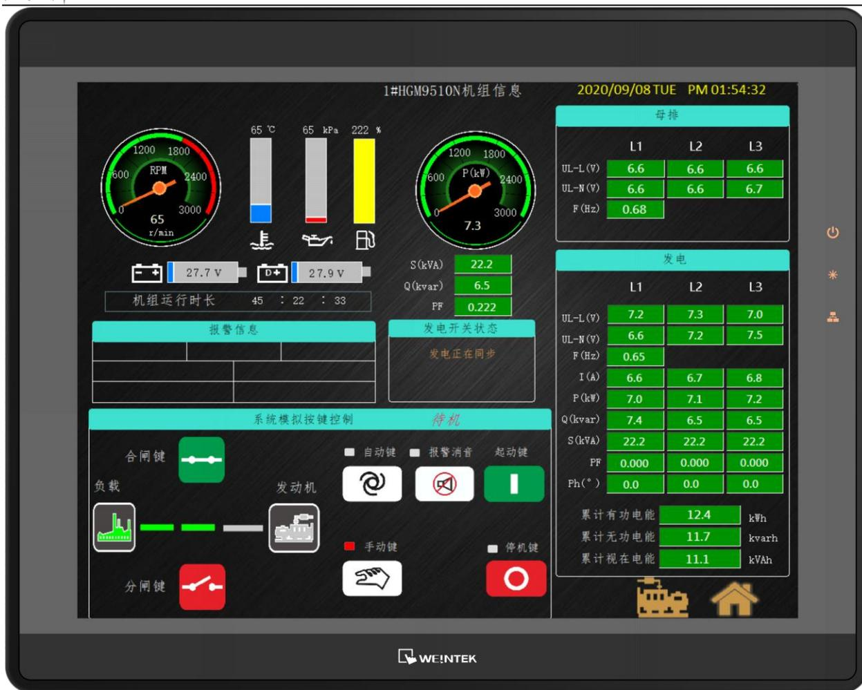
图2 单台 HGM9510N 机组信息显示界面
