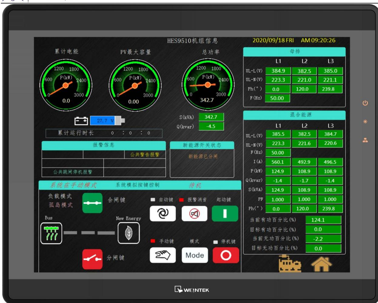
图4 HES9510 机组信息控制器显示界面
